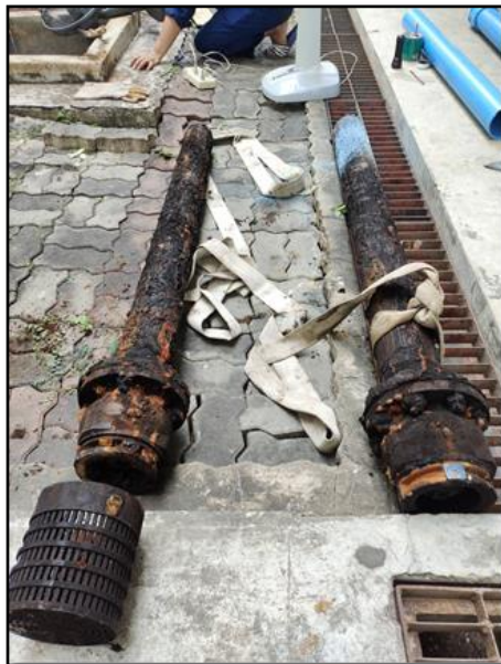
รูปที่ ๑๔ แสดง Foot valve ที่ชำรุด
